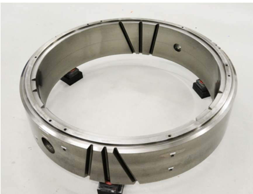
Im Projekt EVeQT entwickeltes werkstückähnliches Großverzahnungsnormale der PTB
