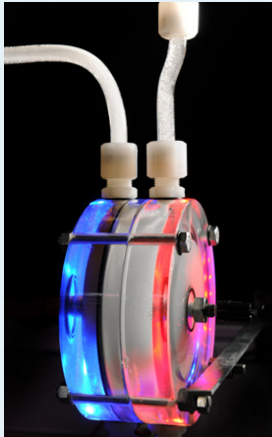
Alkalischer Elektrolysestack: Im Projekt „PlanDelyKaD“ haben Wissenschaftler unter Koordination des DLR die theoretischen Voraussetzungen für die Erprobung eines integrierten Gesamtsystems „Strom-Wasserstoff-Großspeicherung-Nutzung“ in energiewirtschaftlich relevanten Dimensionen untersucht.
