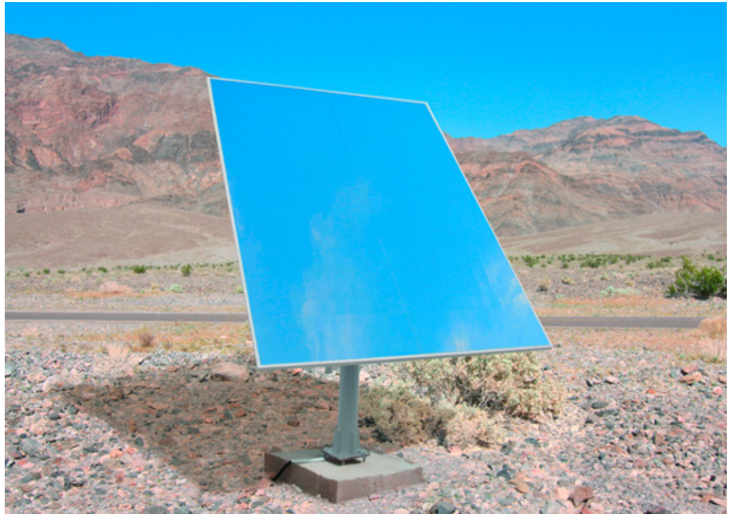
Heliostat der Solar Tower Technologies AG mit fester Horizontalachsenaufhängung
