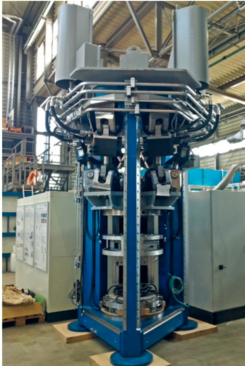
Schweißroboter für Casing-Rohre
